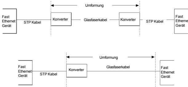
**Wichtiger Hinweis:** Sobald eine Verbindung hergestellt wurde, vergewissern Sie sich, dass beide Geräte korrekt konfiguriert sind, im gleichen Duplex Modus arbeiten und dass die max. Reichweite den IEEE 802.3u Spezifikationen entspricht.
