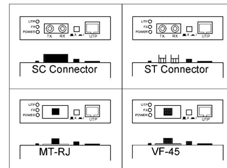
Die genutzte Wellenlänge beträgt 1300nm. Die Konverter unterstützen MM (Multimode) und SM (Singlemode) Glasfaserkabel. Die empfohlene Glasfaser ist 62.5/125µm oder 50/125µm für Multimode und 9/125µm für Singlemode Verbindungen.
