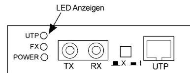
Die mit "UTP" gekennzeichnete LED zeigt den Status des TP-Ports an, die mit "FX" gekennzeichnete LED den des Glasfaserports.
