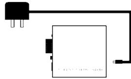
2. Verbinden Sie den Netzadapter mit dem Medienkonverter, bevor Sie den Adapter in die Steckdose stecken.
