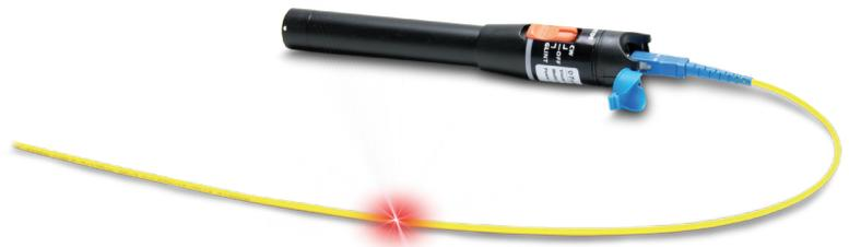
Wo Glasfasern verlegt, konfektioniert und genutzt werden, erleichtert der FiberCheck2 die schnelle und sichere Fehlersuche: Das handliche Gerät koppelt über einen Ferrulenadapter rotes Laserlicht in ein Glasfaserkabel ein. Im Falle eines Bruches der Glasfaser tritt das Laserlicht aus der Faser aus und lässt den Fasermantel hellrot aufleuchten. Auch zu enge Biegeradien oder schlecht konfektionierte Steckverbinder lassen sich so lokalisieren.
